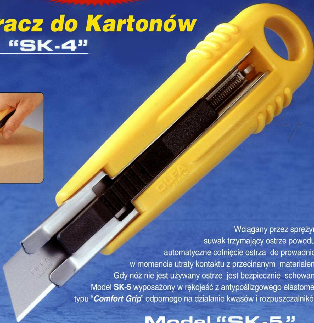
Wciągany przez sprężynę suwak trzymający ostrze powoduje automatyczne cofnięcie ostrza do prowadnicy w momencie utraty kontaktu z przecinanym materiałem. Gdy nóż nie jest używany ostrze jest bezpiecznie schowane. Model SK-5 wyposażony w rękojęść z antypoślizgowego elastomeru typu "Comfort Grip" odpornego na działanie kwasów i rozpuszczalników.
